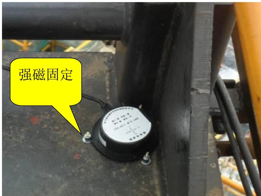
(2) 传感器安装要求紧贴塔机机身，使用水平仪尽量保持平整；
