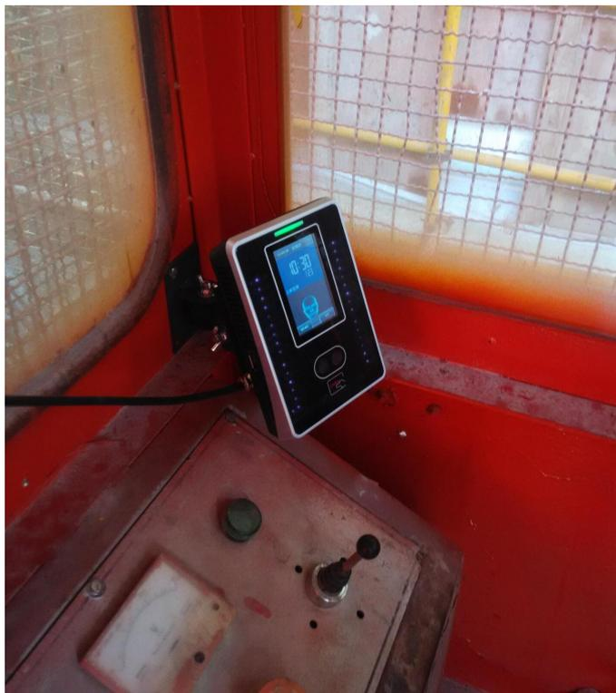
目前单机版的人脸识别系统共有电源、显示、控制、门限位四根线。
